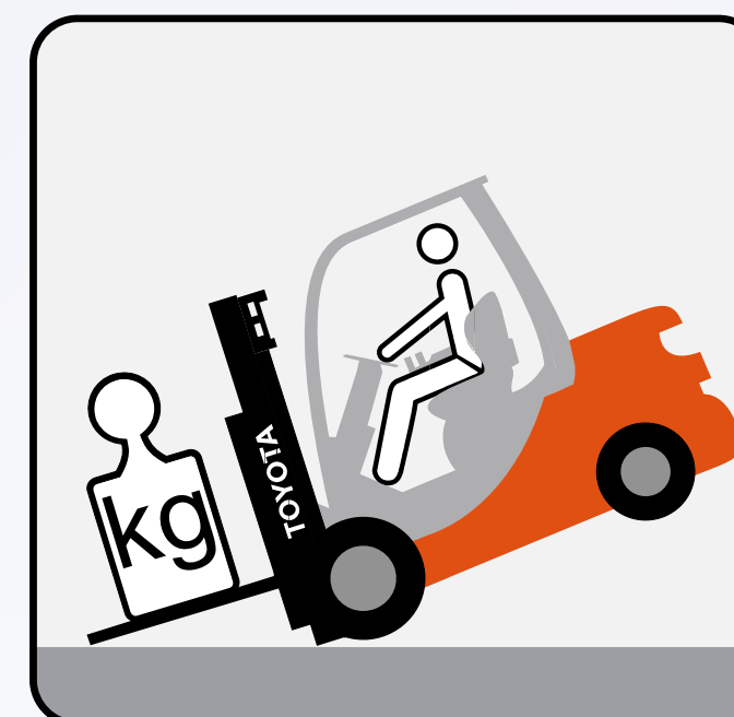
Gaffeltrucki artorsartilluguseqanngisaannarit. Gaffeltruckip usinut diagrammia malittuaannaruk.
