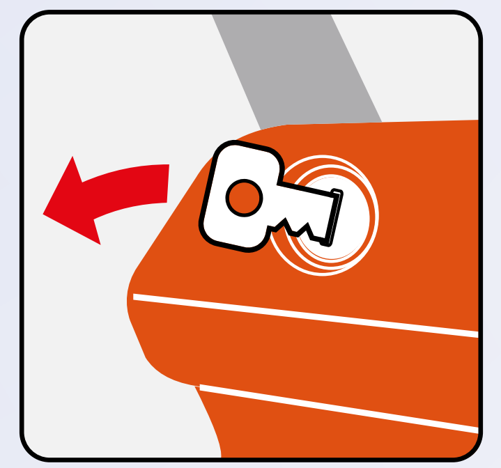
Gaffeltrucki atorunnaarukku inissilluni unittaat ikiguk gaffeltruckilu qamillugu. Ikittaammiit matuersaat peeruk.
